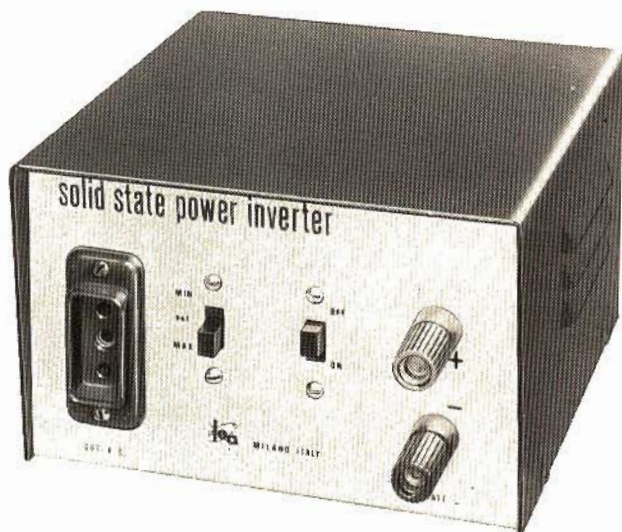
Fig. 1 - Vista frontale dell'invertitore statico della LEA descritto in questo articolo.
