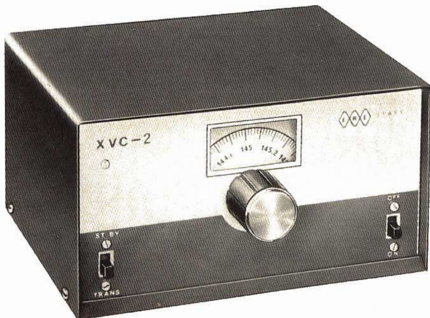
Fig. 1 - Vista frontale del VFO della ERE modello XVC - 2. Si noti la semplicità dei comandi, la compattezza e la facilità di lettura della scala.
