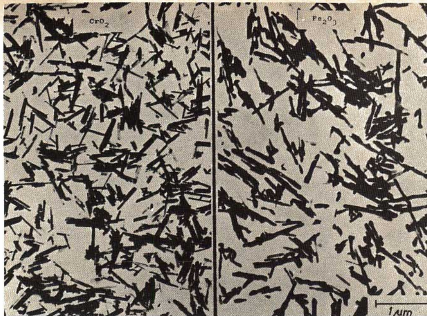
Fig. 6 - Fotografie con forte ingrandimento, che permettono di confrontare le caratteristiche strutturali del nastro al biossido di cromo (a sinistra) con quelle del nastro ad ossido di ferro (a destra).
